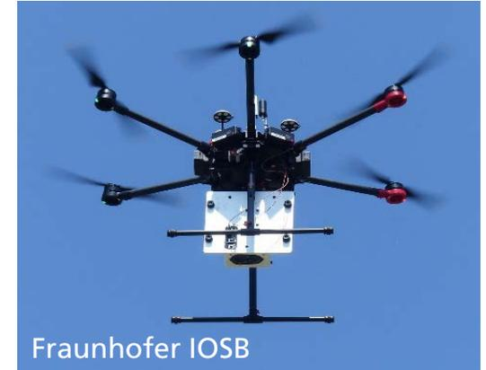
Drohne mit integriertem Hyperspektralsensor
